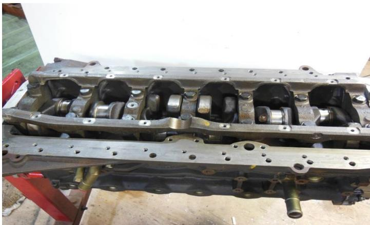
◎エンジンブロック下部の純正のバッフルプレートは前後とも取り外して下さい。
