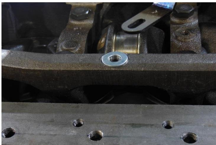
◎アルミOILパンに付属のボルト、ワッシャーを使いバッフルプレートを取り付けてください。
