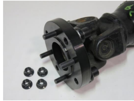
*4 R200-R180 変換アダプター 組み付け例
