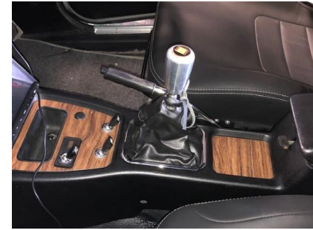
シフトレバー移設ストライキングを取り付けることで3cmシフトレバーが前方に移動します
